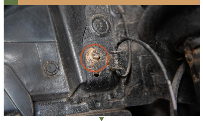
14 RE INSTALL BRAKE LINE BRACKET
