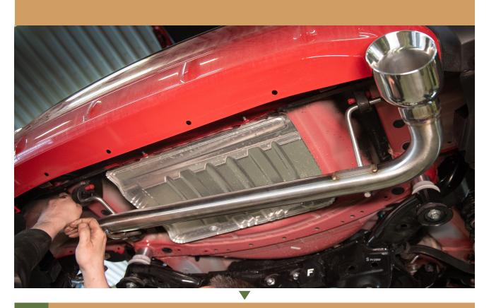
4 ATTACH THE MUFFLER DELETE USING THE SUPPLIED GASKET AND BOL
